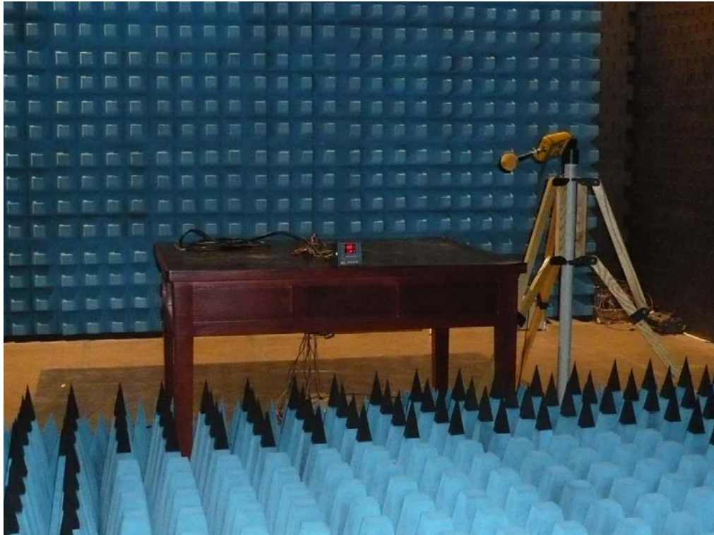
图 3: 射频电磁场辐射抗扰度检验配置图
