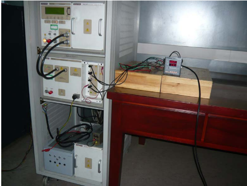
图 1: 振荡波抗扰度检验配置图
