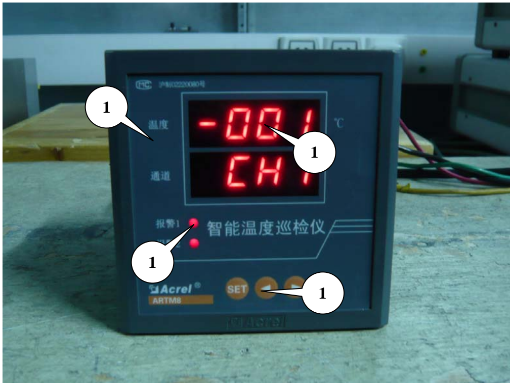
图 2: 静电放电抗扰度检验配置图及典型检验点位置图 (注: 1 - 空气放电部位)
