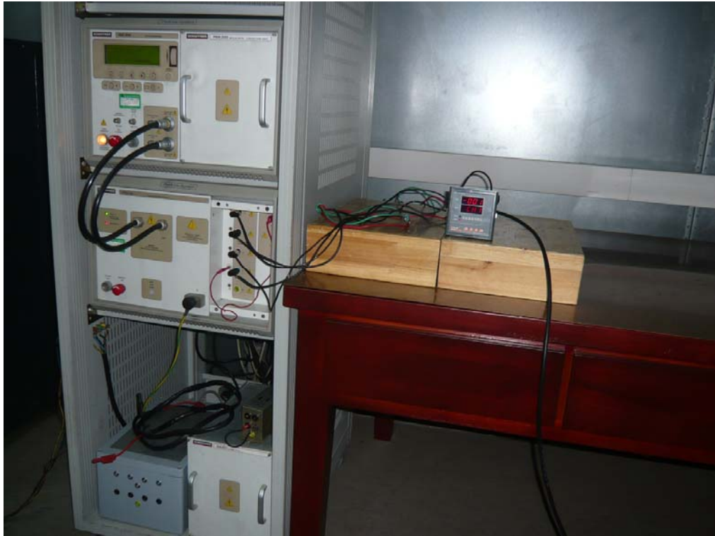
图 5: 浪涌抗扰度检验配置图
