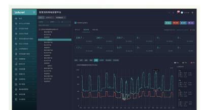
消防水子系统可以接入消防栓、消防水压、水位传感器等，用于实时的监控消防水管网的压力、液位、是否漏水，以及开盖等事件，当消防水压不够，管网漏水时，系统也能实时地发出警报，能让相关人员及时维修维护，保障消防安全。
