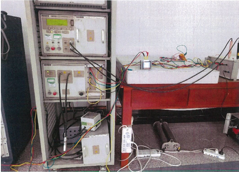
图 3: 浪涌干扰检验配置图
